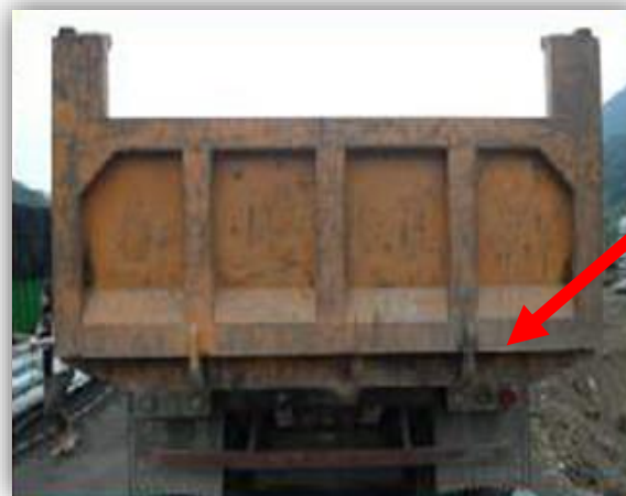
貨箱後檔門關閉後， 污水、污泥不得滴 落於地面
